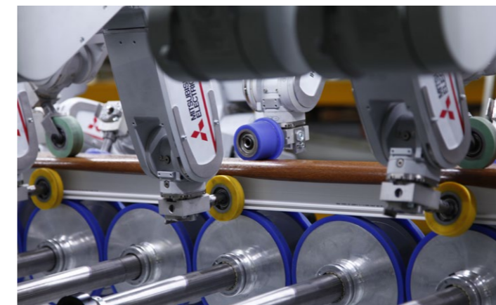
Präzision auf Knopfdruck: 24 Roboterarme stellen eine erstklassige Folierung sicher – bei Bedarf kann ihre Zahl noch weiter erhöht werden
